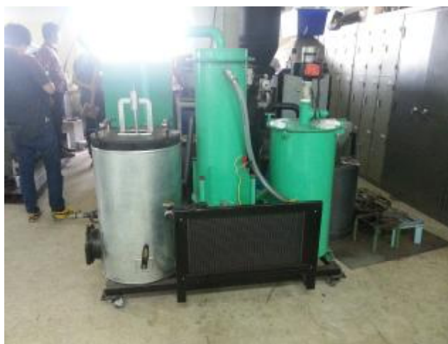
ภาพที่ 5 ตัวอย่างระบบเครื่อง gasification ขนาดเล็ก ของภาควิชาวิศวกรรมเครื่องกล คณะวิศวกรรมศาสตร์และเทคโนโลยีอุตสาหกรรม มหาวิทยาลัยศิลปากร
